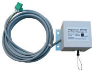
Der Frontschiebersensor (linearer Wegsensor) stellt ein stabiles Spannungssignal (0...10V DC), in Abhängigkeit von der vertikalen Frontschieberöffnung, zur Verfügung. Dieses Spannungssignal ist absolut stabil und störungsfrei und somit ausgezeichnet als Führungssignal für den Regler FC500 geeignet.
